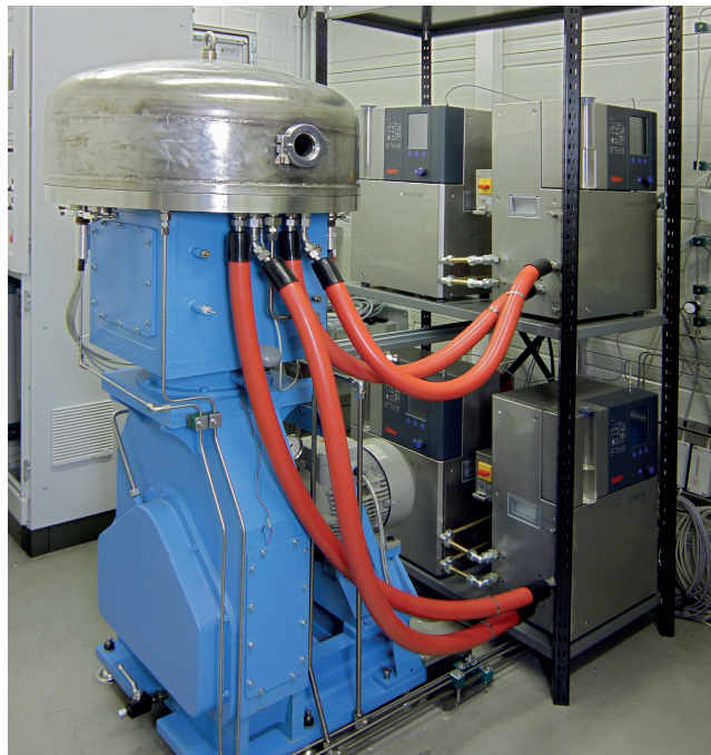
Bild 2. Aufbau der Prallsichtermühle zum feinen Vermahlen von PTFE-Abfällen: Dieser Zerkleinerungsschritt ist notwendig, um die für das Recycling notwendigen geringen Korngrößen zu erreichen. Quelle: Neuman & Esser Process Solutions; Grafik: © Hanser
