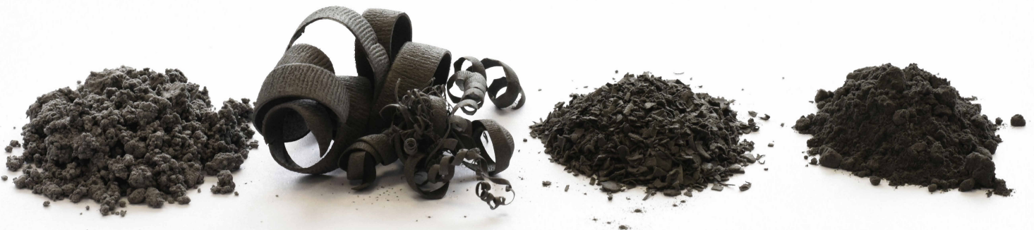
Im Gegensatz zu den meisten anderen Thermoplasten können bei PTFE nicht einfach Flakes der Neuware zugemischt werden (v.l.n.r. Original-Pulvermischung, Späne, zerkleinerte Späne, Mahlgut) © Stasskol
