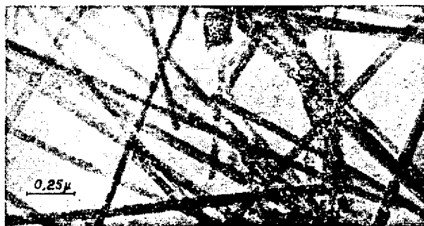
Fig. 12a. — Fibres de chrysotile Cassiar non traitées.
