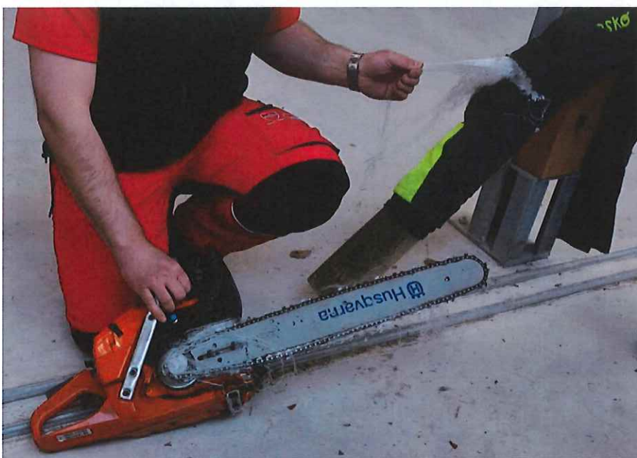
Eine Schnittschutz-Demo zeigt auf eindruckliche Art und Weise die sofort blockierende Wirkung der herausgerissenen Kunstfasern.
