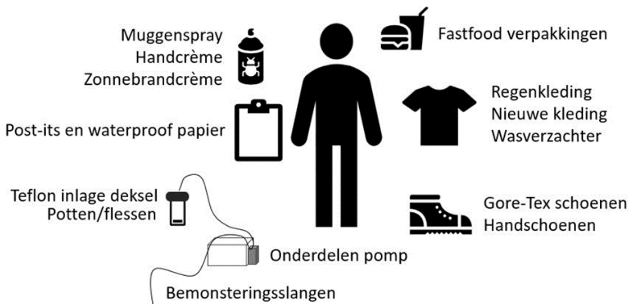
Figuur 9: Schematische weergave van aandachtspunten bij het vermijden van kruiscontaminatie (bron: Expertisecentrum PFAS).
