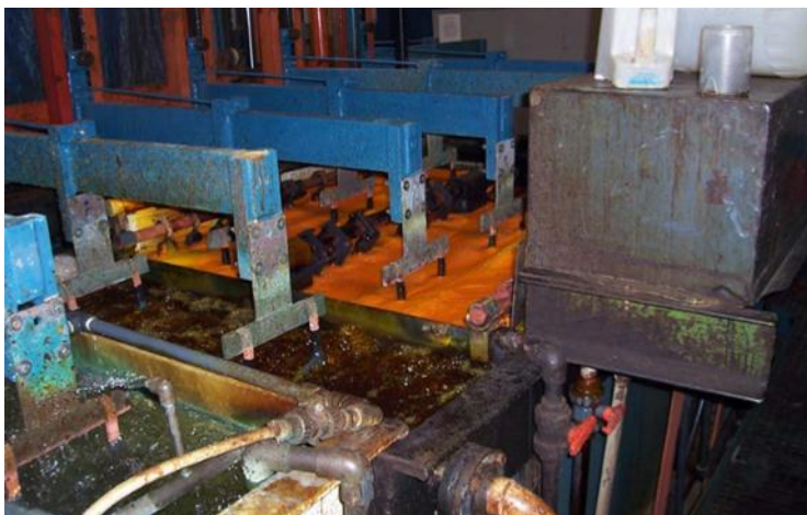
Figuur 4: Verchromingsbad (met oranje schuim) met spoelbaden (EPA, 2009)
