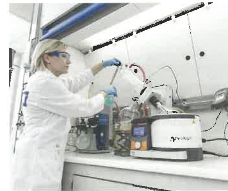
Im H2O-Labor wird die PFAS-Reduktion durch Vakuumverdampfung nachgestellt und gemessen
